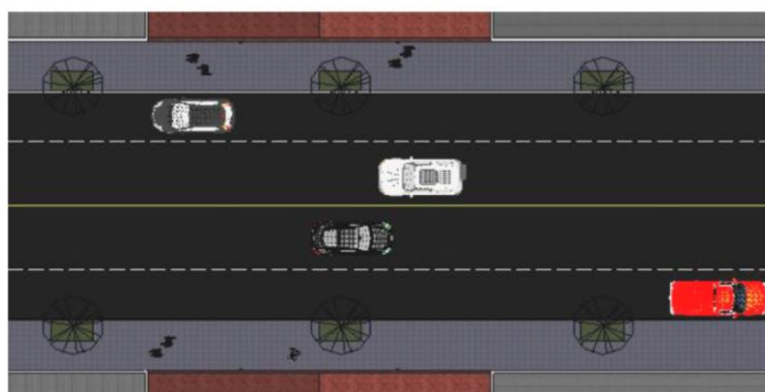
ESPAÇO ÁRVORE PARA CALÇADAS MAIORES DO QUE 2,5m DE LARGURA EM NOVOS LOTEAMENTOS
